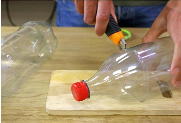
a. Schneide den „Kopf“ einer PET-Flasche mit dem Cutter ab (etwa 15 cm unter dem Verschluss).
