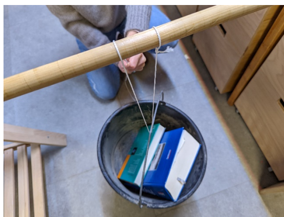
6) Fahrt mit dem Faden durch den Henkel des Eimers, dann wieder hoch und über den Besenstiel. Zieht am freien Fadenende, bis ihr den Eimer mitsamt Gewicht hochhebt.
